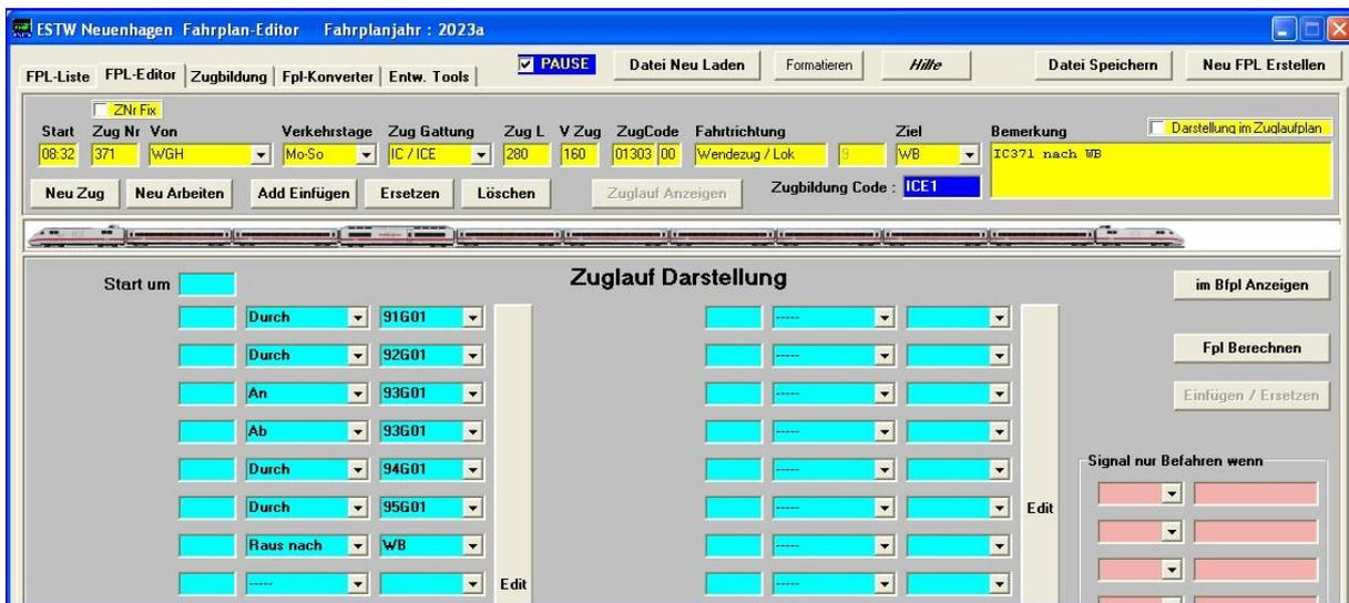
Als nächstes wird nun der Button „**Fpl Berechnen**“ gedrückt. Dabei wird die Startzeit aus dem oberen Fahrplanneditor nach unten in den Zuglauf-Editor in die erste Zeile geladen und dient nun als Basis für die Berechnungen. Jetzt erscheinen die Zeiten:
