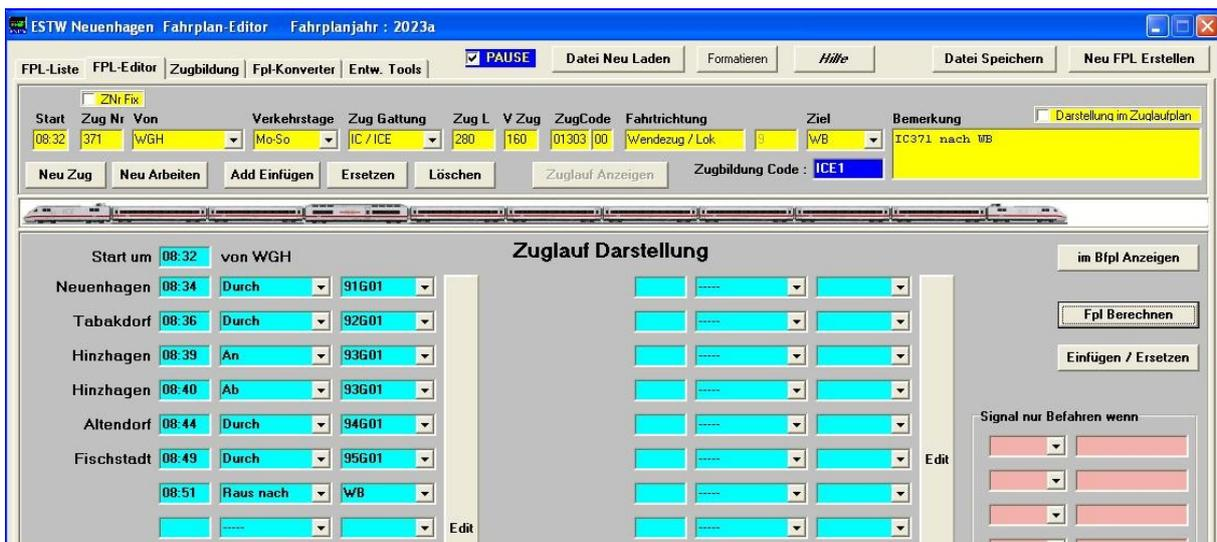
Die automatische Berechnung hat einen Zug-Halt von einer Minute eingebettet. Die Abfahrtszeit kann nun manuell geändert werden. Mit einem erneuten Klick auf „**Fpl Berechnen**“ werden die Zeiten ab der Abfahrt neu berechnet.
